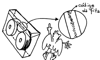
Fita magnética com sinais magnéticos codificados
