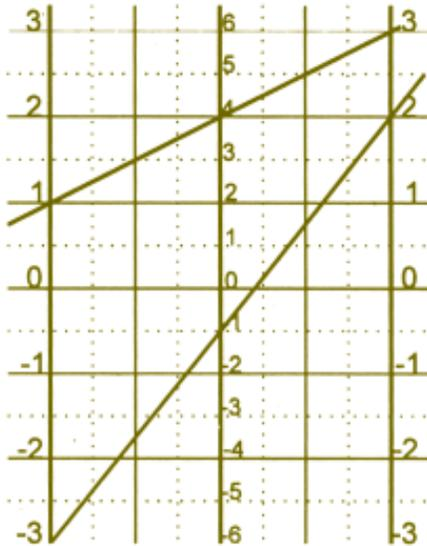
Para determinar a soma de dois números  $a$  e  $c$ , marcamos  $a$  no eixo  $A$  e  $c$  no eixo  $C$ . A soma  $a + c$  será determinada pela interseção da reta que une os pontos  $a$  e  $c$  com o eixo  $B$ .
