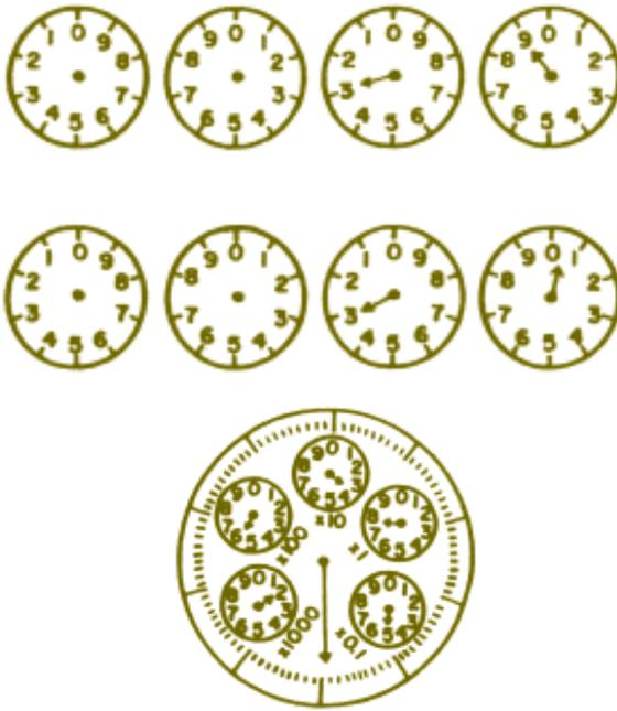
A figura à esquerda ilustra um medidor de consumo de água, e a leitura é 1 537,5 m<sup>3</sup>.
