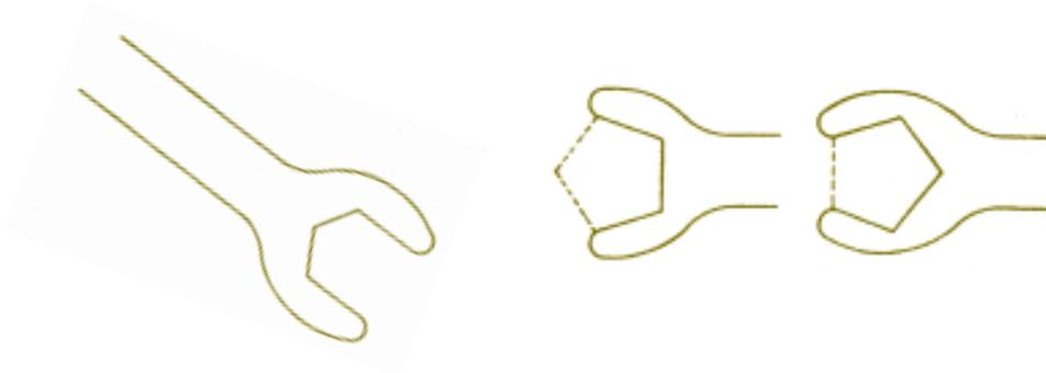
A primeira tem a desvantagem de “escapar” com facilidade e a segunda só se encaixaria na cabeça do parafuso com este movimento:
