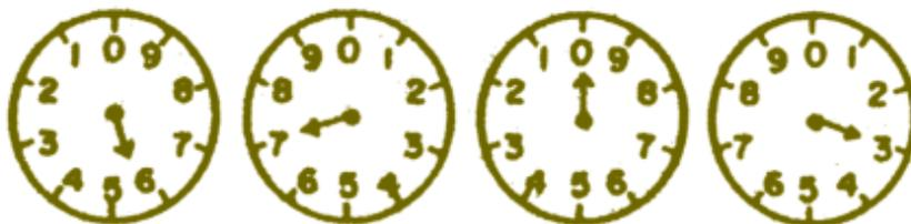
A figura acima ilustra o esquema do mostrador de um medidor, onde o consumo é dado em *kWh* (quilowatt-hora). Esse esquema é cópia do verso de uma conta de luz: seus quatro ponteiros indicam, na ordem em que aparecem, os algarismos 5 – 7 – 0 – 3. Portanto, para fazer a leitura corretamente basta anotar, na ordem em que aparecem, um algarismo para cada ponteiro, tomando o de menor valor dentre os dois entre os quais se encontra o ponteiro (ou o 9, se o ponteiro estiver entre 0 e 9).
