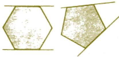
Isto significa que a chave usada para o parafuso hexagonal tem, no encaixe, bordos paralelos, o que facilita o ajuste da chave à cabeça do parafuso.
