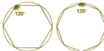
O ângulo interno do hexágono regular mede 120°, e o do octógono regular, 135°. A chave usada para apertar ou desapertar um parafuso nunca se ajusta perfeitamente à sua cabeça. Sempre existe uma folguinha. Com o uso, a tendência da cabeça é sofrer um arredondamento (dizemos que a cabeça do
