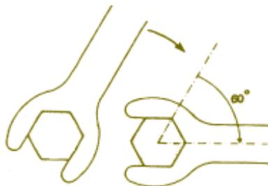
Quando um mecânico está concertando um defeito qualquer numa máquina – por exemplo, um automóvel – muitas vezes ele tem pouco espaço para trabalhar (em geral em posições desconfortáveis). Por esta razão, dos três parafusos apresentados, o mais cômodo é o hexagonal, pois é o que pode ser apertado ou desapertado com giros menores ( $60^\circ$ ), isto é, com movimentos mais curtos do braço.
