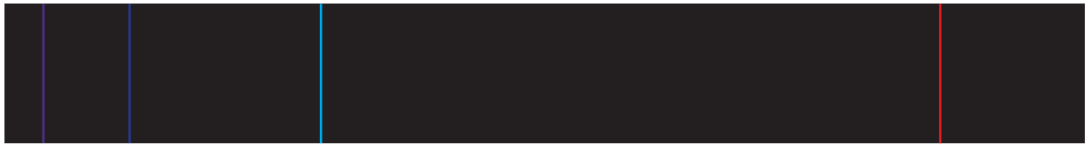
15- As quatro linhas de emissão da série de Balmer do Hidrogênio. A linha vermelha à direita é H\alpha .
