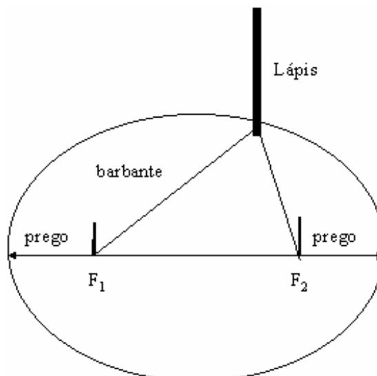
Fig. 6. Esquema do método do jardineiro para desenhar uma elipse
