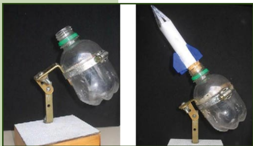
Figura 4.87A e B. Segunda plataforma montada (a) e o foguete encaixado (b).
