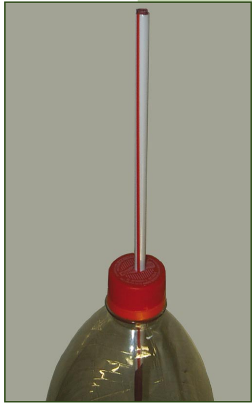
Figura 4.79. Foguete-canudinho. Dentro do canudo grosso preso na tampinha da garrafa PET está um canudo ligeiramente mais fino e tapado com palito de fósforo na extremidade superior.
