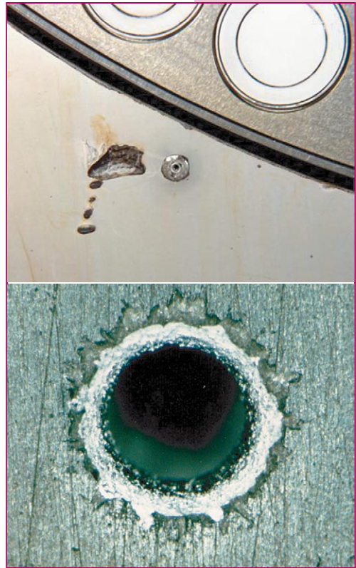
Figura 5.21A e B. Dano causado por lixo espacial ou micrometeorito a um satélite.
