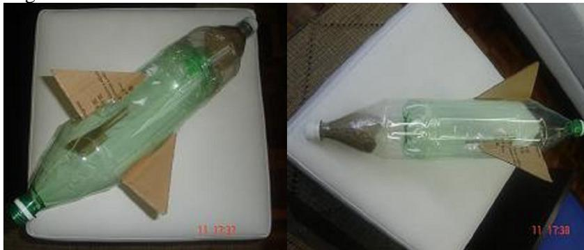
Figura 5. Foguete com bico, aletas e “bocal”.
