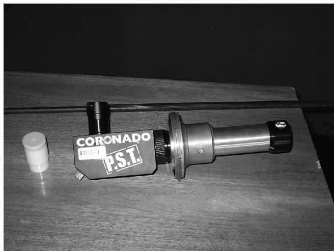
Figura 7 - O telescópio PST da CORONADO que possui um filtro hidrogênio-alfa
