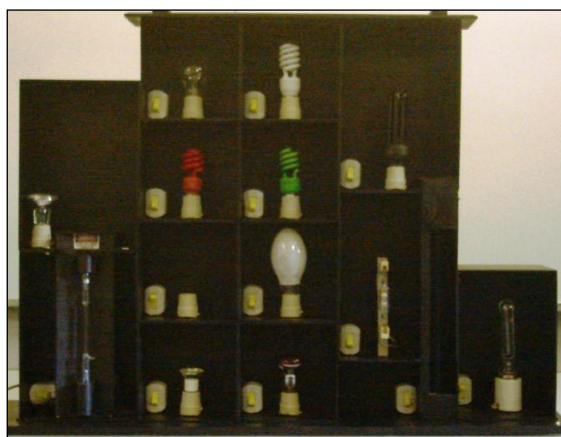
Figura 10: Quadro de lâmpadas no Observatório. Da esquerda para a direita e décima para baixo, lâmpada de: LED, Gás Hélio, Incandescente, Fluorescente vermelha, Dicróica, Fluorescente branca, Fluorescente verde, Mista, Incandescente vermelha, Luz negra, Metálica, Vapor de Mercúrio e Vapor de Sódio.
