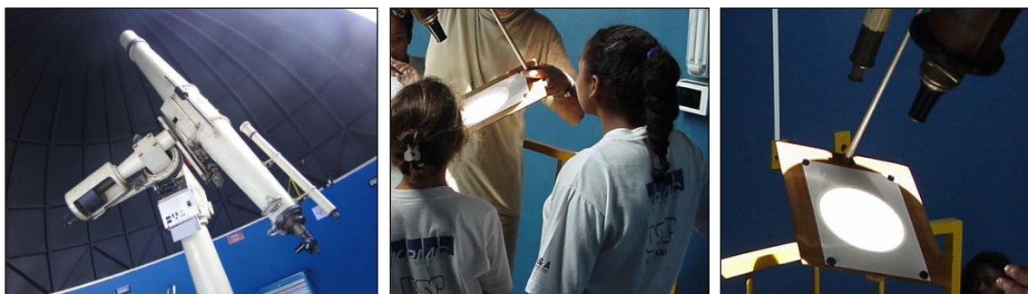
Figura 6: Telescópio Refrator Grubb. A imagem à direita mostra uma visão geral do telescópio refrator. As imagens mostram o Sol sendo projetado em um anteparo. Fonte: Observatório Dietrich Schiel
