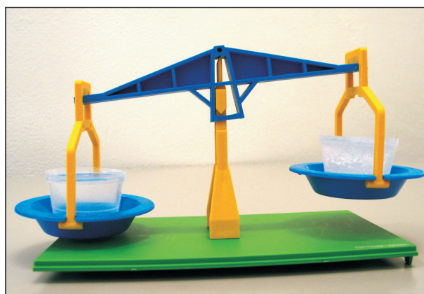
Figura 13: Comparação dos pesos de mesmo volume de água líquida (esquerda) e gelo (direita).
