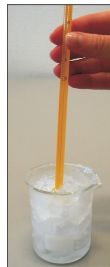
Figura 11. Medindo a temperatura de fusão do gelo.
