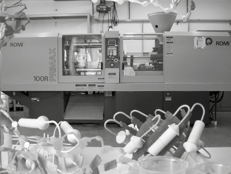
Máquina injetora de plástico e materiais didáticos produzidos
